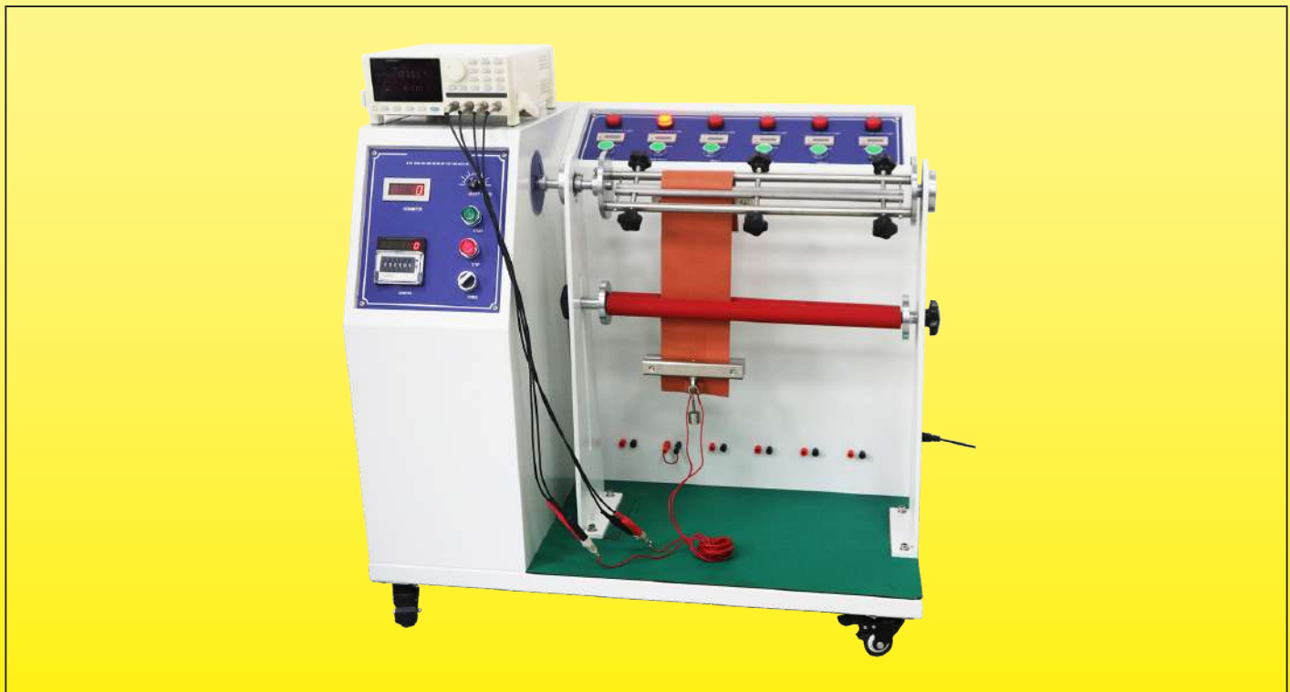
Calentador de silicona flexible durante la prueba de flexión
