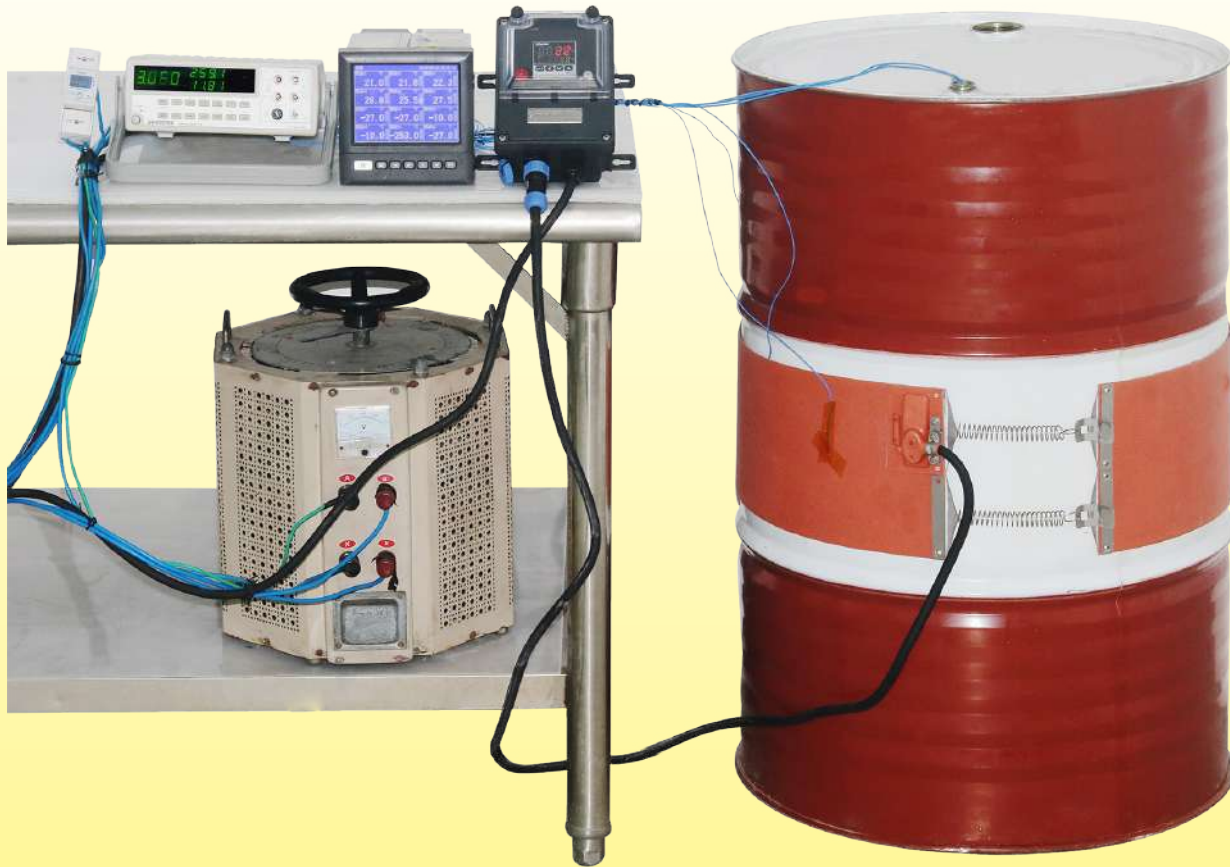
Variación de la temperatura versus el tiempo de un tambor de metal de 220 litros, lleno de agua , calentado por una cinta calefactora de silicona de 200 mm de ancho, sin aislamiento térmico, potencia de 1500 W (carga superficial de 0,5 W/cm² ).
