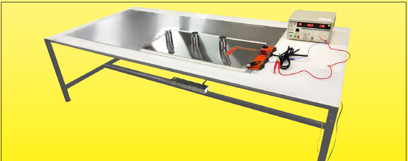
Equipo de medición para la corriente total de fuga en frío
